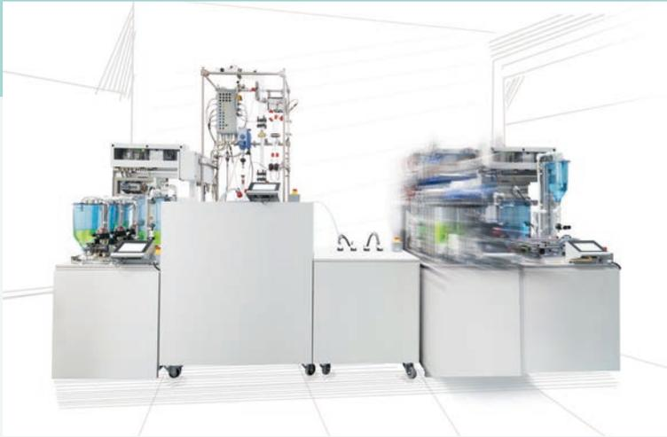
Mit dem Anlagen-demonstrator beweist WAGO, dass die DIMA-Methodik nicht nur praktikabel ist, sondern den Austausch ganzer Anlagenmodule in weniger als drei Minuten ermöglicht.
