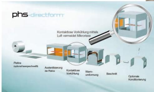
phs-directform®: der Pionier für verzinkte, in direkter Warmumformung pressgehärtete Bauteile
