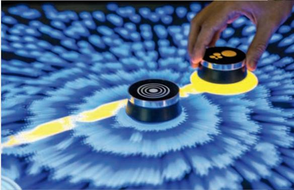
Eine neuartige Software-Lösung in Verbindung mit kapazitiven 3M-Multitouch-Displays ermöglicht eine einfache und zuverlässige Objekterkennung.
