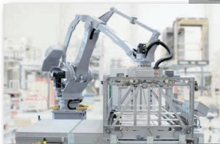
Langhammer präsentierte unlängst eine Kombination aus Knickarmroboter, Fördertechnik und Lagengreifer. Die Systemlösung von Langhammer ist auf geringsten Raumbedarf und höchste Palettierqualität ausgelegt.
