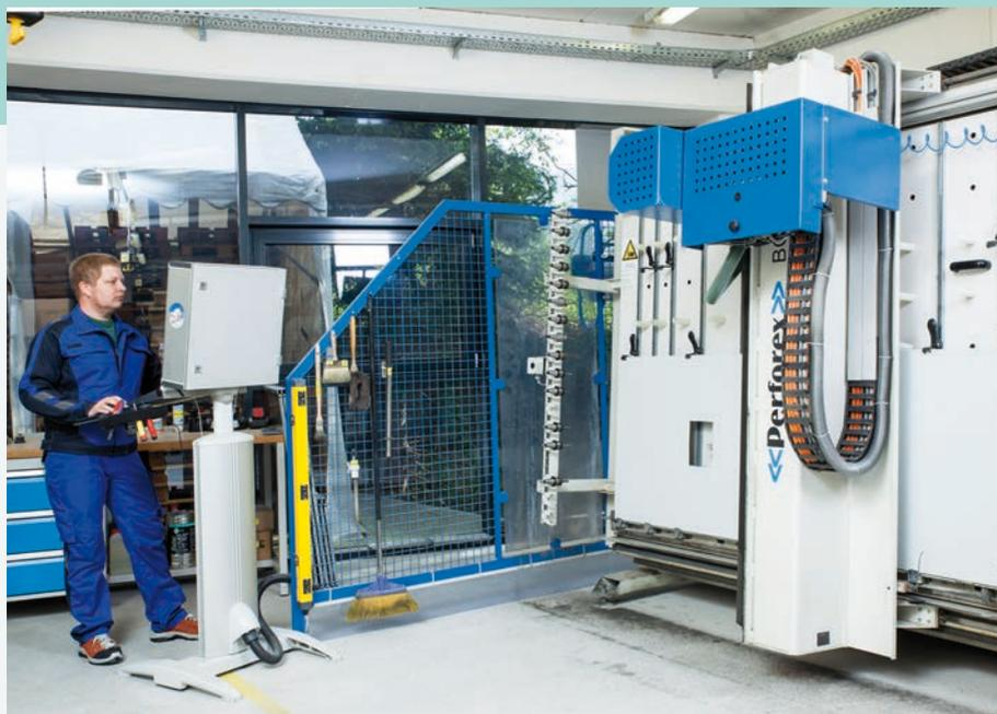
Früher musste nachträglich noch viel im Schaltschrank oder auf der Montageplatte gebohrt werden. Das gibt es jetzt alles nicht mehr. Das Werkstück ist nach der Bearbeitung mit der Perforex spanfrei und wird so bestückt.
