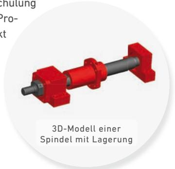
3D-Modell einer Spindel mit Lagerung
