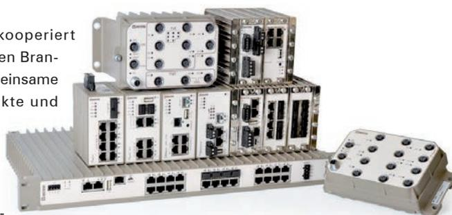
Schwedische Switches und Routers (mit Firewallfunktion) für ausfallsichere Infrastruktur- und Industrienetze
