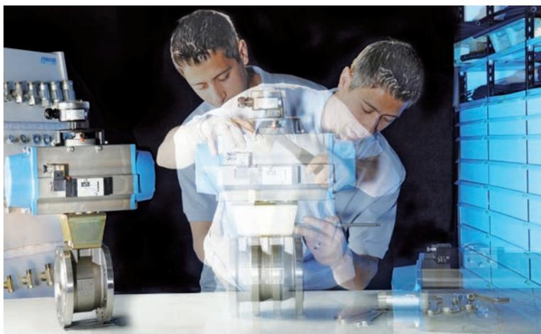
*Montage eines Kugelbahns mit pneumatischem Drehantrieb*
