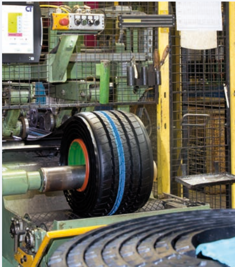
10.000 Tonnen Laufstreifen für die Reifen-Runderneuerung laufen bei KRAIBURG Austria jährlich vom Band.
