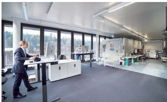
Flexibler Indoor-Strahlenschutzcontainer direkt im Bürobereich
