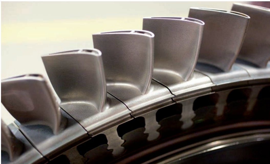
Siemens testete erstmals vollständig mit Additive Manufacturing (AM) gefertigte Gasturbinenschaufeln in konventionellem sowie neuem Schaufeldesign unter Vollast in einer Gasturbine.
