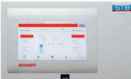
Die Steuerung der komplexen Bühnentechnik erfolgt über einen Panel-PC.
