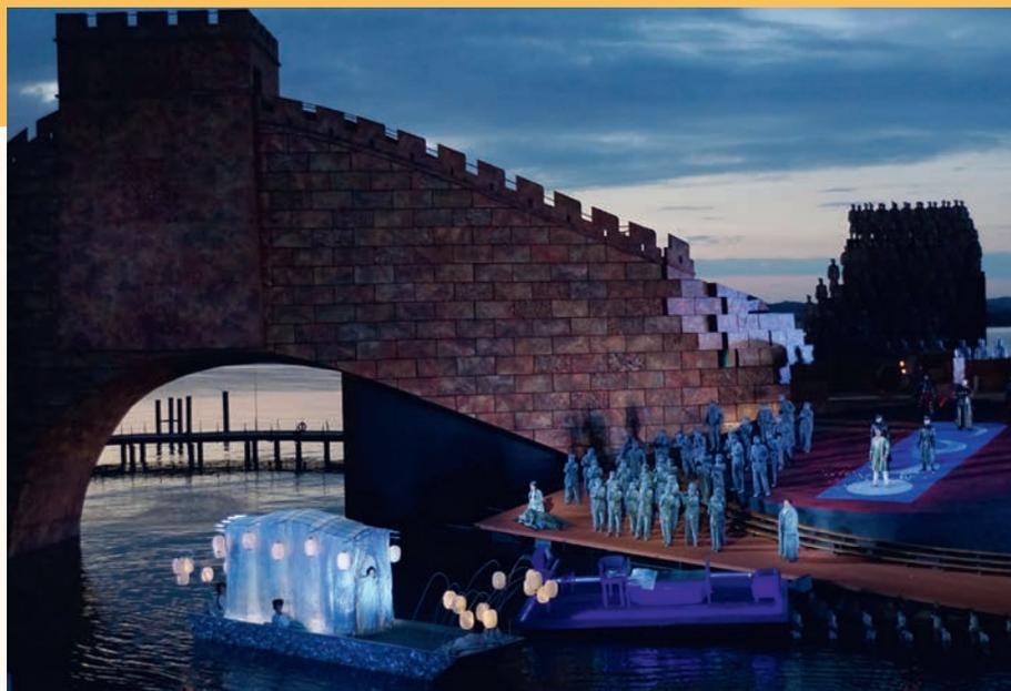
Ein besonderer Effekt des Bühnenbildes ist ein Boot, das scheinbar wie von selbst die Bühne umkreist. Es ist auf einem Hubscherenaufbau montiert, der unter der Wasseroberfläche auf einem 260 Meter langen Schienensystem bewegt wird.
