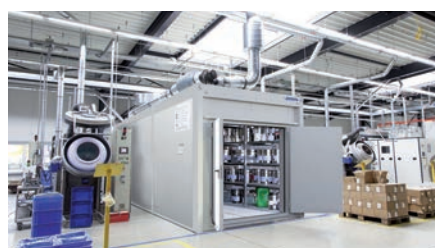
WFP als Farbmischstation inmitten der Produktion (li.) oder als Kleingebindelager (re.)
