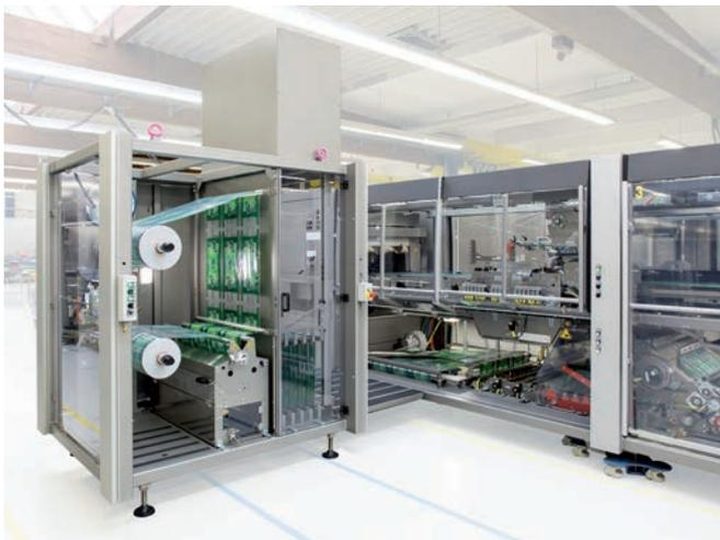
Dieser stelle fest, ob die aktuell verwendete Folie bis auf ein bestimmtes Minimum abgerollt wurde. Trete dies ein, werde parallel zur Produktion automatisch der Speicher befüllt.
