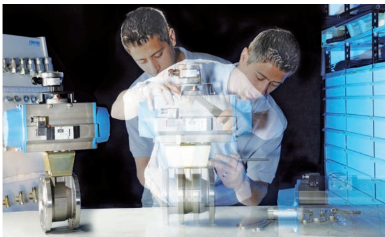
Montage eines Kugelbahns mit pneumatischem Drehantrieb
