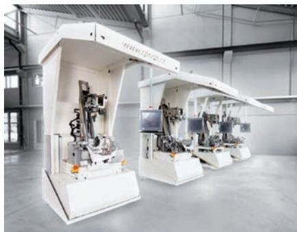
Manuelle Mess-Richtanlagen für KFZ-Karosserieteile „Strukturteile“
