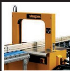
Hochleistungsmaschinen zum voll- bzw. halbautomatischen Umreifen
