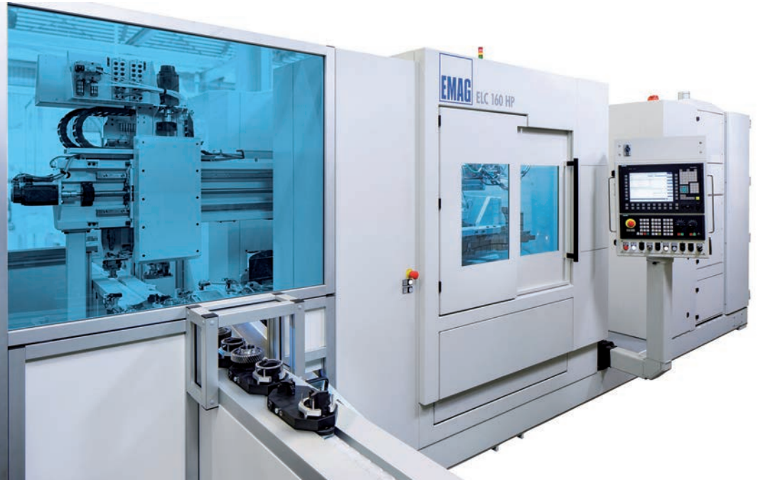
Links: Induktives Vorwärmen zum Schweißen: Das Bauteil erreicht in wenigen Sekunden die benötigte Bearbeitungstemperatur.
