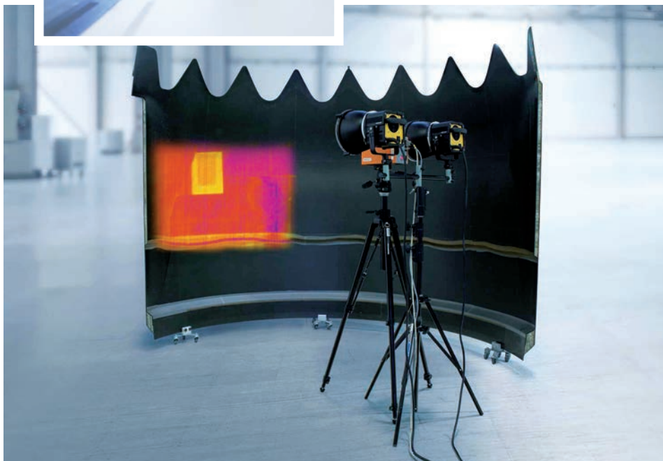
Die von FACC entwickelte „aktive Thermografie“ ist schneller und günstiger als die herkömmliche Methode zur Kontrolle von Flugzeugbauteilen.
