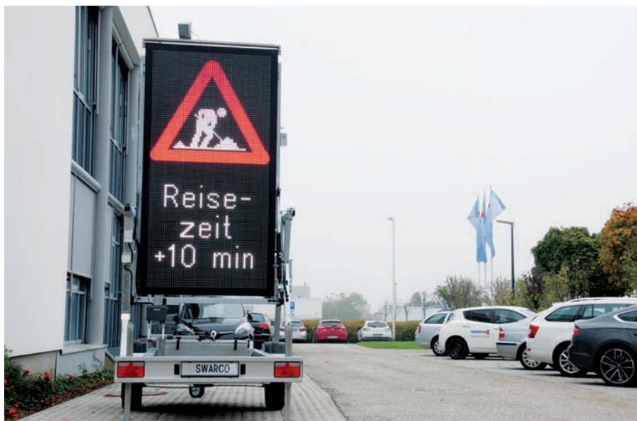
Der Baustellen-Warnanhänger liefert Informationen in Echtzeit – auch in vernetzte Fahrzeuge.
