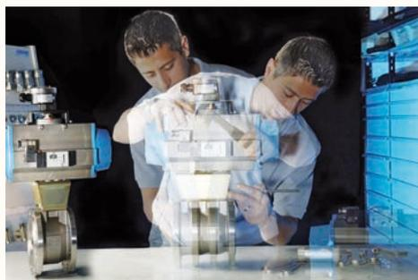
Montage eines Kugelhahns mit pneumatischem Drehantrieb
