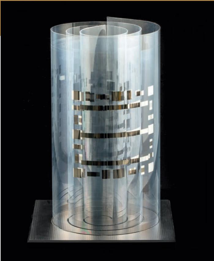
Bei der photochemischen Metallisierung werden Kunststofffolien mit einer photoaktiven Schicht aus Metalloxid-Nanopartikeln überzogen.
