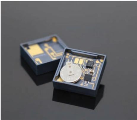
besitzen 3D-MID-Teile mit einer rein chemisch abgeschiedenen Metallisierung in der Regel eine geringere Kupferschichtdicke. Sie eignen sich somit weniger für Anwendungen, bei denen es auf hohe Ströme und Stromdichten ankommt, wie zum Beispiel in der Leistungselektronik. Diesem Umstand kann jedoch durch eine galvanische Verstärkung der Kupferschichtdicke entgegen gewirkt werden, sodass sich die Einschränkungen auf technologische Extreme begrenzen. ■
