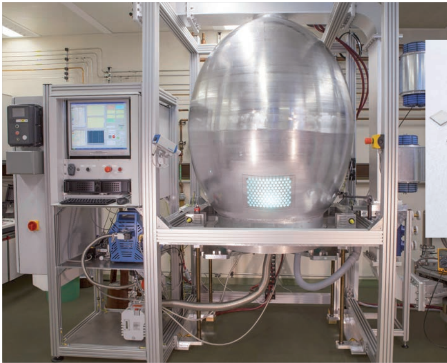
Die besondere Ellipsoid-Form des am Fraunhofer IAF entwickelten Plasma-Reaktors ermöglicht das großflächige Abscheiden von Diamant.
