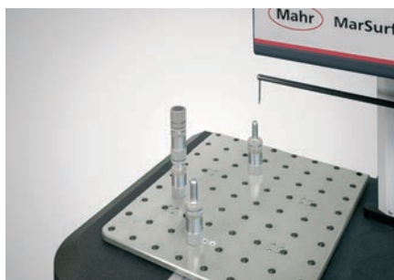
Aufnahmeplatte mit „Schraubbock-Set“ inkl. Spitzenaufnahme und Magnethalter
