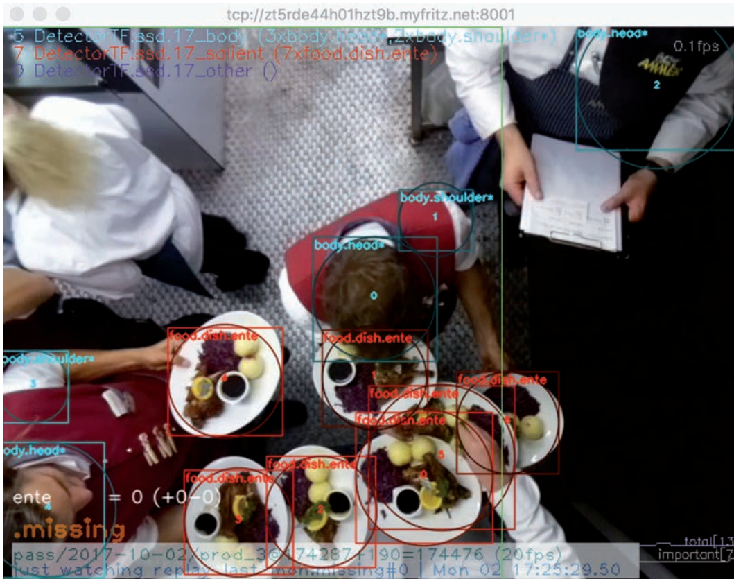
Livemonitoring „Dishtracker“ – Kooperation im Bereich Computer Vision und Real-time Object Tracking ermöglichen Speisenerkennung und Abrechnung in Echtzeit.
