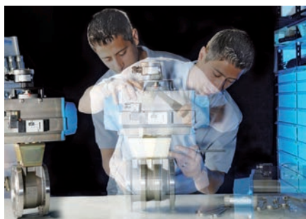
Montage eines Kugelbahns mit pneumatischem Drehantrieb
