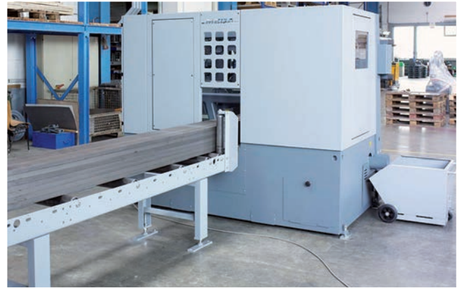
Der MEBAmat 330 verfüge über eine hydraulisch vorgespannte seitliche Hartmetall-Rollenführung.
