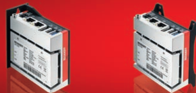
Flexible Montagemöglichkeiten an der Rück- oder Seitenwand.
