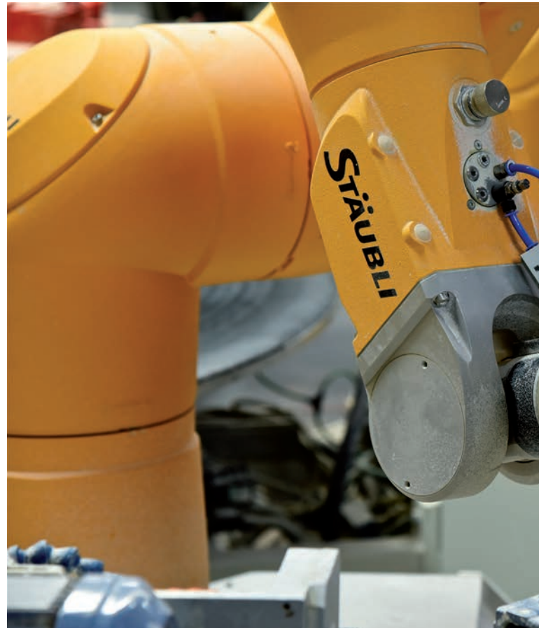
Links oben: Der große Sechssachser RX160 bei der Entnahme eines Artikels aus der Kunststoffform nach dem Hochdruckgießen. Darunter: Mit höchster Präzision übernimmt der Stäubli-Roboter das Verschwammen der formvollendeten Rosenthal-Kollektion „Free Spirit“.
