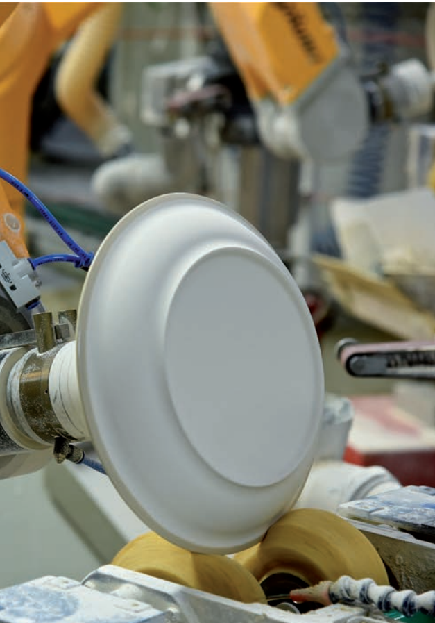
Mitte: Präzise Staubli-Sechssachser TX90 sichern beim Trockenpressen perfekte Qualität der Teller durch sorgfältiges Verschwammen. Rechts: Dank seiner großen Reichweite kann der RX160 ein breites Aufgabenspektrum – darunter hier im Bild das Entgraten – ausführen.
