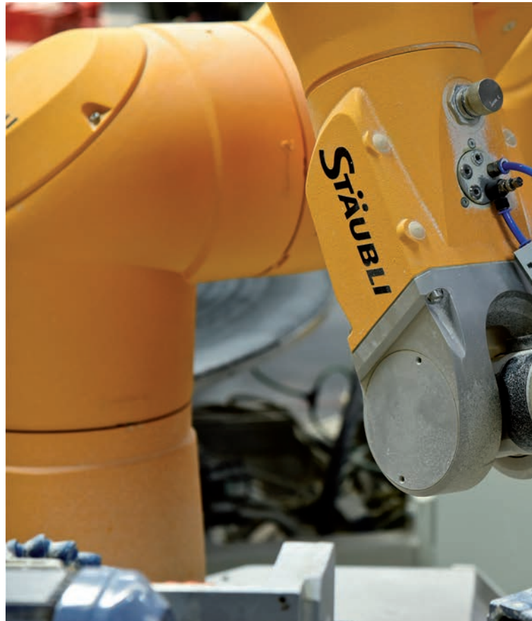
Links oben: Der große Sechsixer RX160 bei der Entnahme eines Artikels aus der Kunststoffform nach dem Hochdruckgießen. Darunter: Mit höchster Präzision übernimmt der Stäubli-Roboter das Verschwammen der formvollendeten Rosenthal-Kollektion „Free Spirit“.
