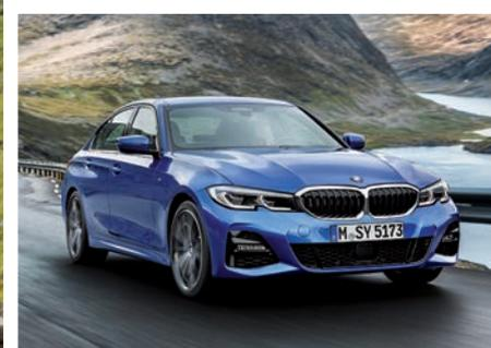
rekten Einfluss auf das ebenso souveräne wie agile Fahrverhalten haben der um 41 auf 2.851 Millimeter erweiterte Radstand sowie die vorn um 43 und hinten um 21 Millimeter erhöhten Spurweiten.
