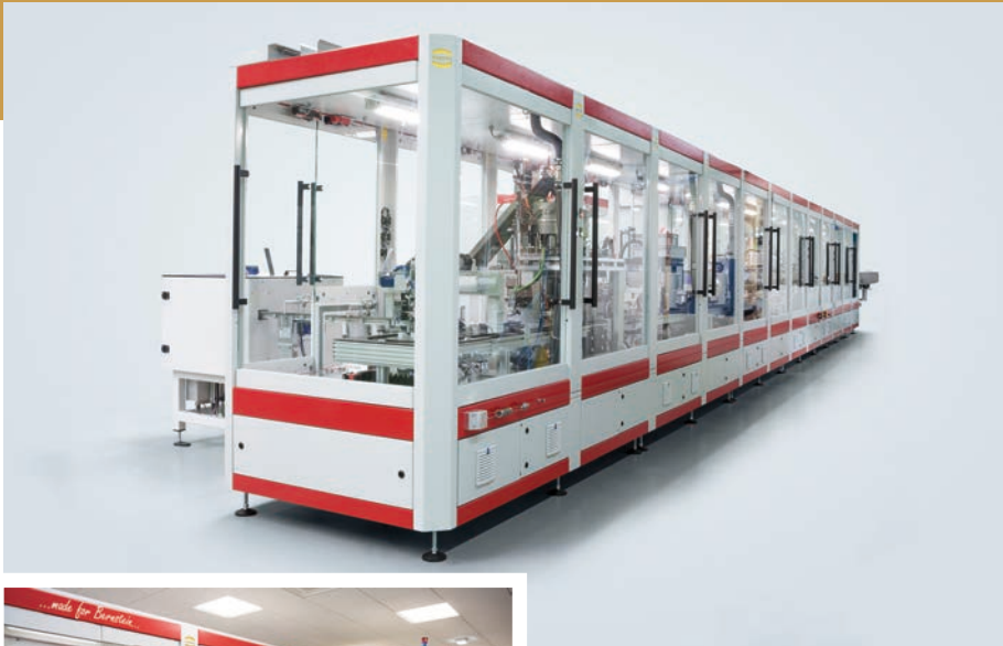
Die Anlage montiert die neue BERNSTEIN-Schal- tergeneration C14 in unterschiedlichen Varianten vollautomatisch.
