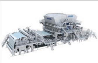
**+** Der internationale Technologiekonzern ANDRITZ erhielt von Berli Jucker Cellox Ltd. den Auftrag zur Lieferung einer PrimeLineCOMPACT-VI-Tissue-Maschine mit Schuhpresse inklusive Stoffaufbereitung und Automatisierungssystem für das Werk in Prachinburi, Thailand. Die Maschine produziert hochqualitatives Tissue-Papier im Flächengewichtsbereich von 13 bis 40 Gramm pro Quadratmeter.
