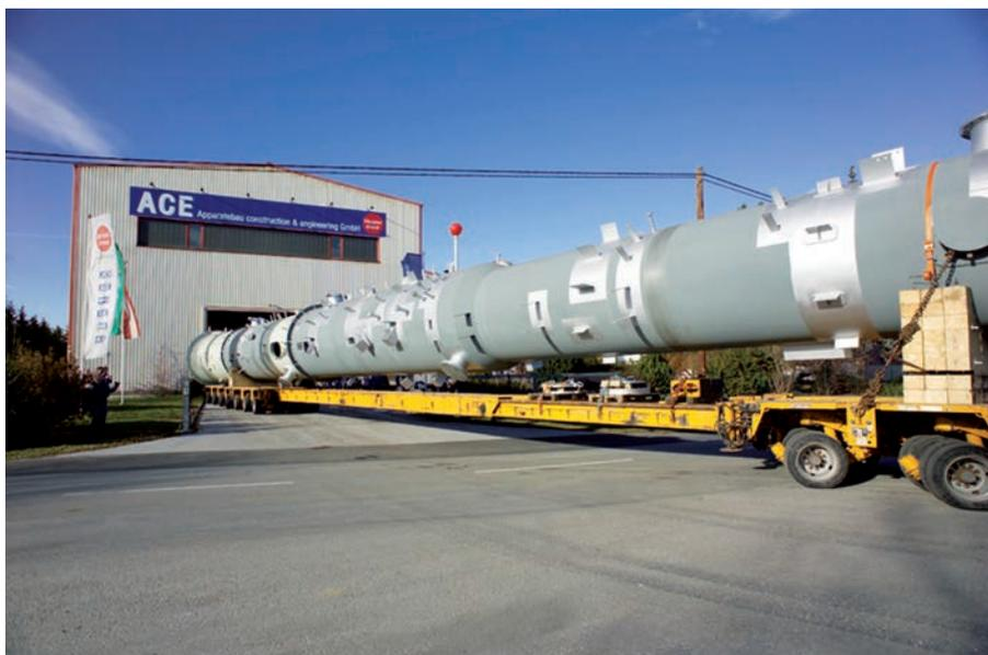
Fertige Kolonne verlässt die Produktionshalle.
