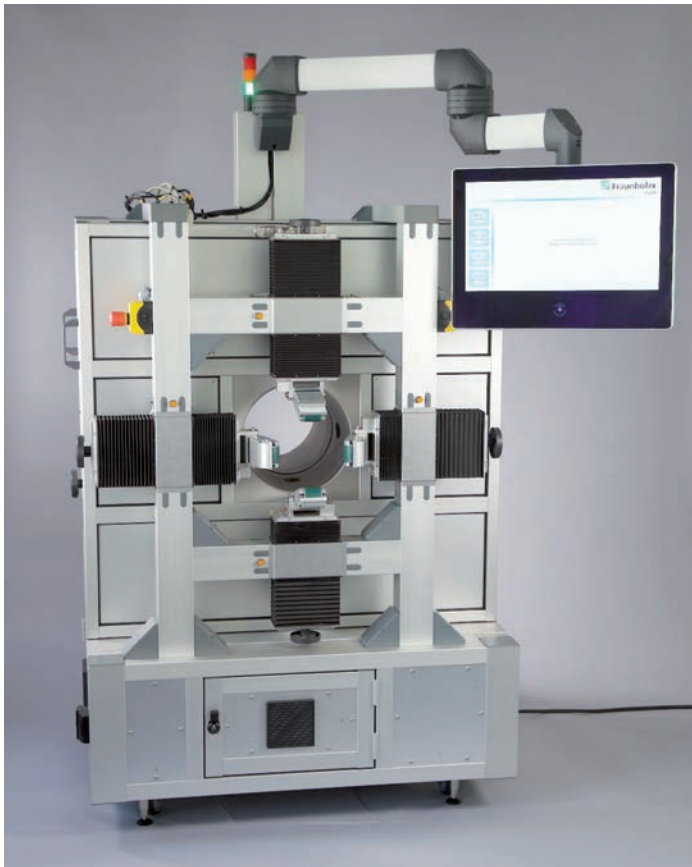
Terahertz-Messsystem mit vier parallelen Messköpfen zur Inline-Kontrolle von beschichteten Kunststoffrohren.
