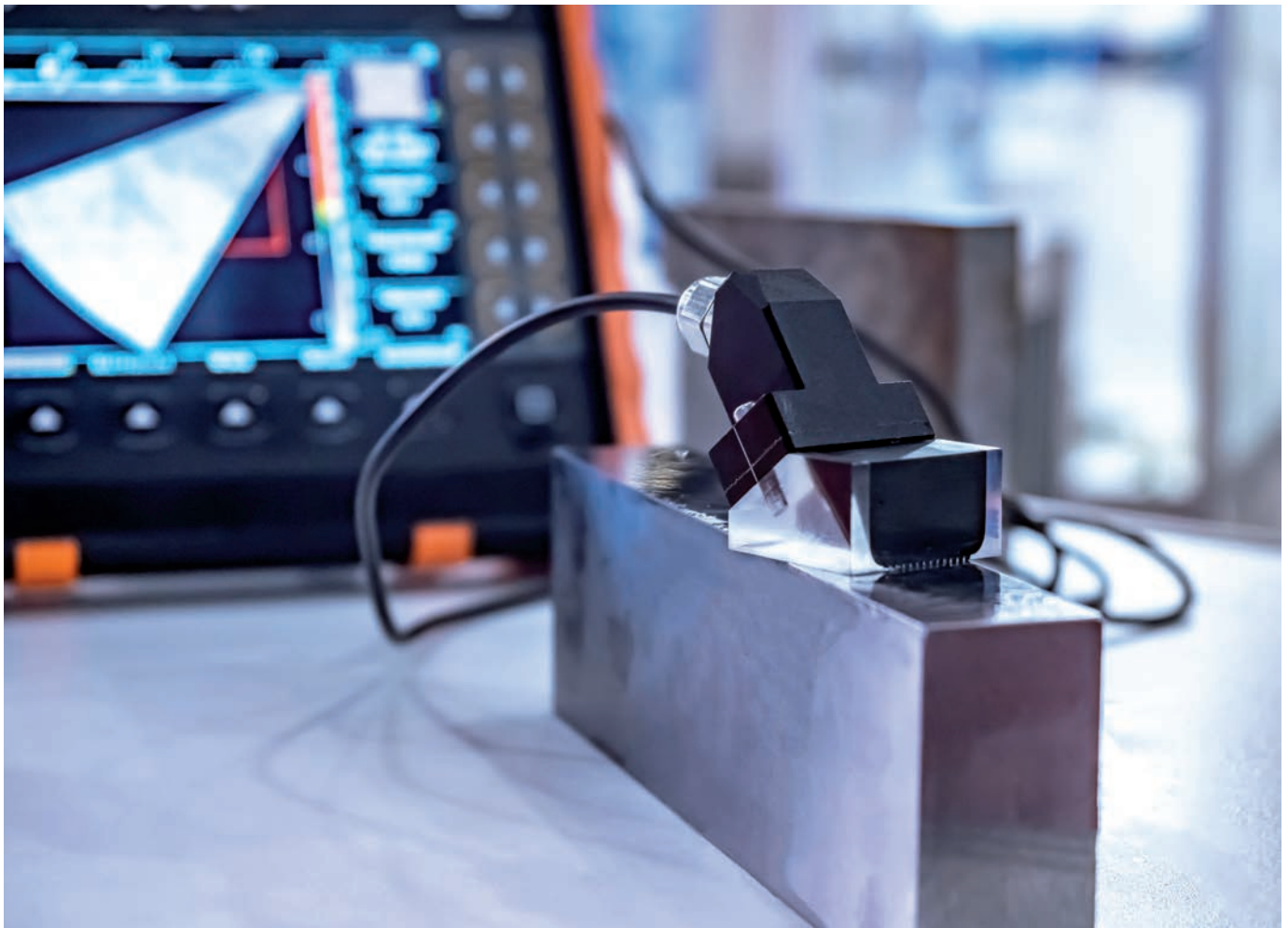
Eine regelmäßige Kalibrierung von Messinstrumenten ist notwendig, da diese durch Alterungsprozesse und Umwelteinflüsse im Laufe der Zeit Abweichungen aufweisen können.
