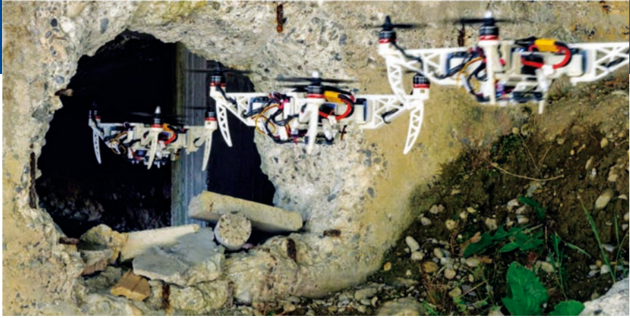
Clever: eine Drohne, die ihre Rotoren anlegt, wenn sie durch ein zu kleines Loch schweben will.
