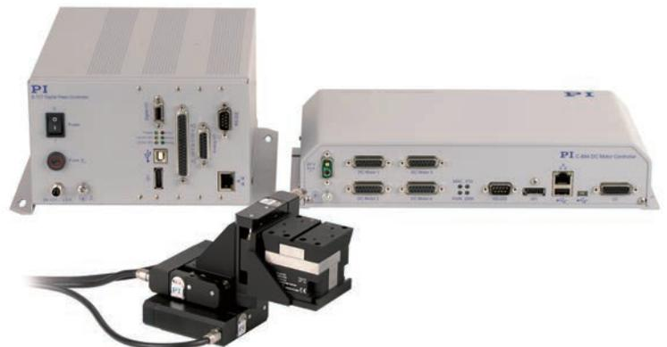
Aufbau von drei Lineartischen mit DC-Motor mit jeweils 15 mm Stellweg sowie einem geregelten NanoCube-XYZ-Piezosystem, welches hohe Geschwindigkeit bei 2 nm Auflösung bietet. Das System werde komplett mit Controllern sowie einem umfangreichen Softwarepaket angeboten, welches die grafische Bediensoftware PIMikroMove und Programmierschnittstellen für die Einbindung in Anwenderprogramme enthalte.
