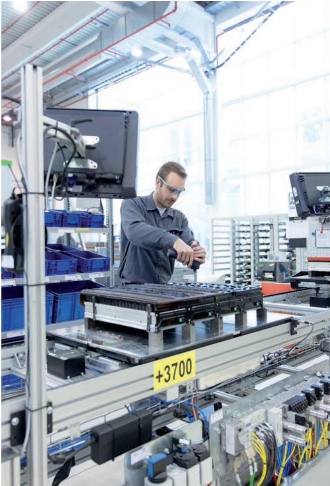
SDI-Akku-Packs bestehen aus einzelnen prismatischen Zellen, die zu Modulen weiterverarbeitet werden. Die aktuelle Jahresproduktion beläuft sich auf rund 70.000 Batterien.
