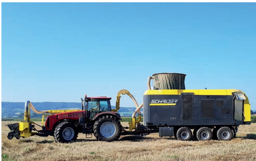
Innovation aus NÖ: Pelletec D 8.0 – die erste funktionsfähige mobile Erntemaschine, die aus Stroh, Heu, Luzernen, Energiepflanzen und Reststoffen direkt am Feld gebrauchsfähige Pellets produziert und so nachhaltig zur Reduzierung der Luftverschmutzung beiträgt.
