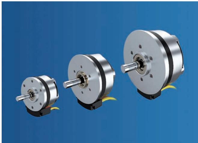
die Motoren nur 14, 16 und 21 mm lang, liefern aber Drehmomente bis 134 mNm bei einem Durchmesser von 22 mm, 32 mm bzw. 42 mm. Sie sind für eine Dauerausgangsleistung von bis zu 100 W ausgelegt und übertreffen damit die Maßstäbe dieser Antriebsklasse deutlich, insbesondere im Hinblick auf das Verhältnis von Drehmoment zu Länge, Volumen und Gewicht, was Anwendungen bei beengten Platzverhältnissen zugutekommt.
