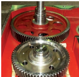
Getriebegruppen für Papiermaschine (re.)
