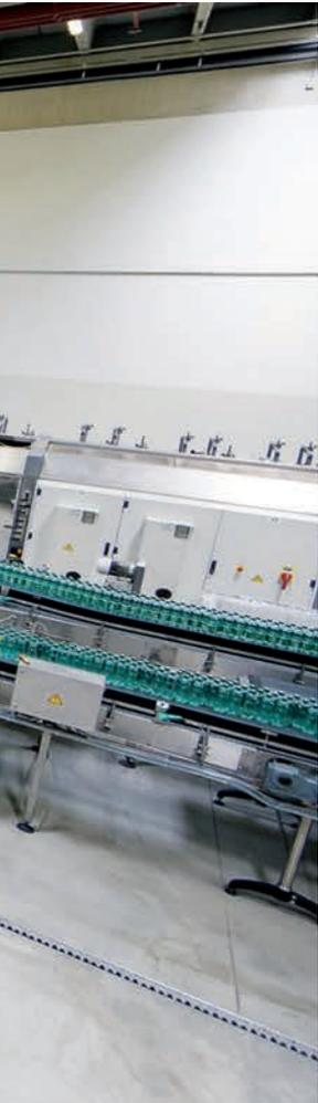
Anfang 2016 ging eine hochmoderne High-Speed-Linie in Betrieb. Mit 45.000 Flaschen pro Stunde – dies entspricht mehr als zwölf Flaschen pro Sekunde – zählt die Glasanlage zu den schnellsten Linien und arbeitet dabei ausgesprochen energieeffizient.
