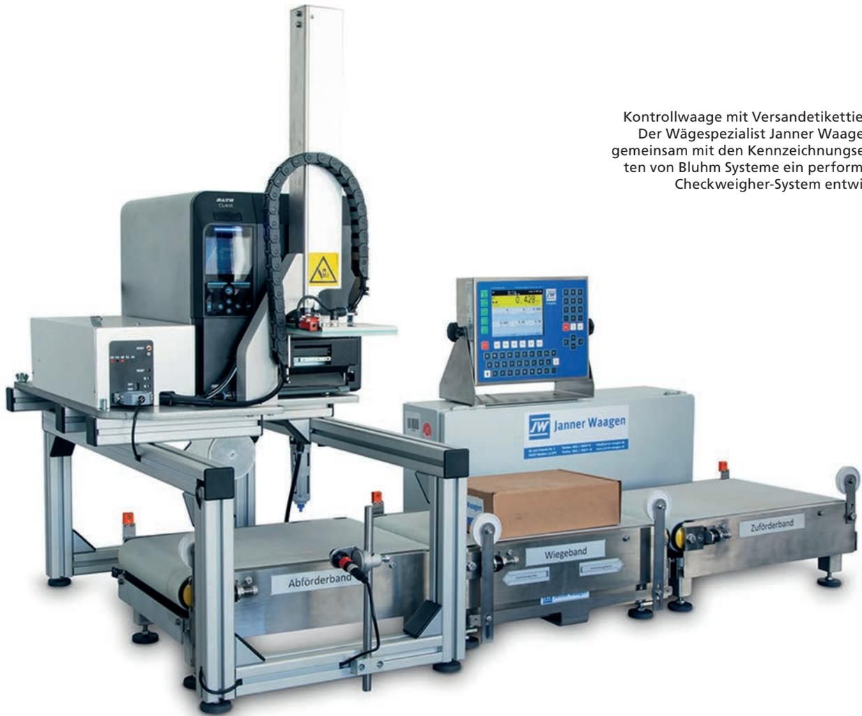
Kontrollwaage mit Versandetikettierung:
