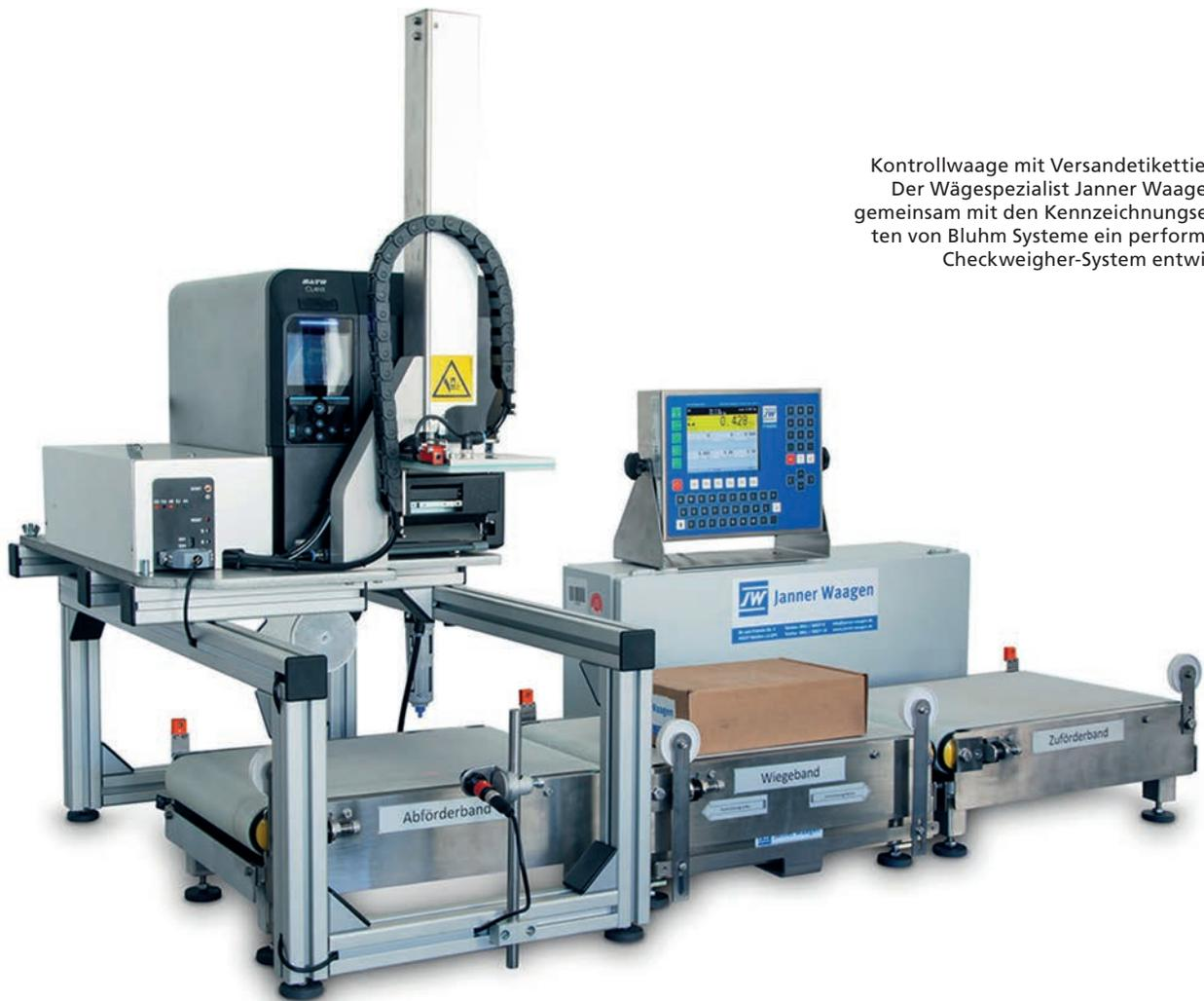
Kontrollwaage mit Versandetikettierung:
