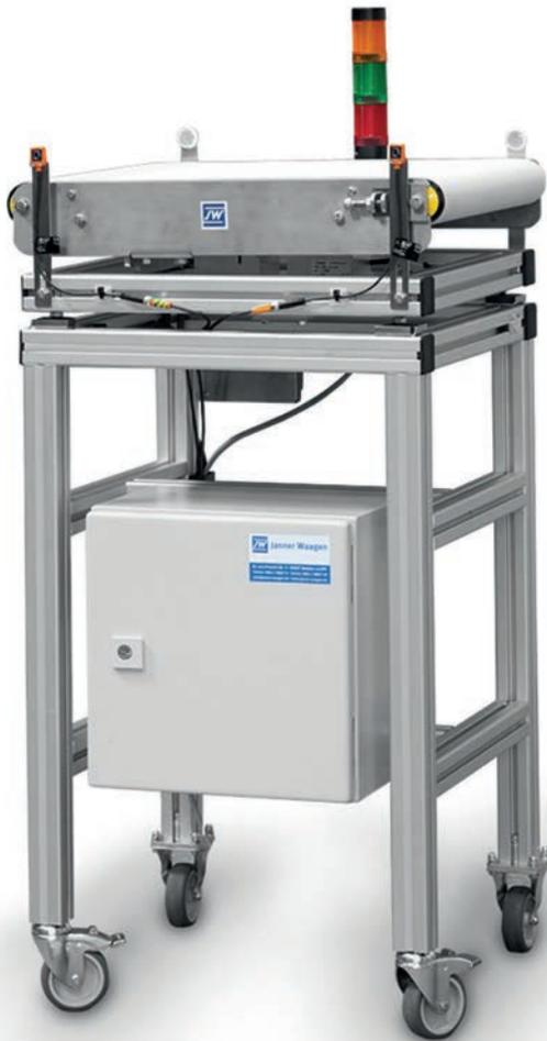
Der Checkweigher dient zur statischen und dynamischen Kontrollwägung bzw. zur Überwachung von Toleranzwerten in der Fertigungskette bei mittleren und hohen Geschwindigkeiten.
