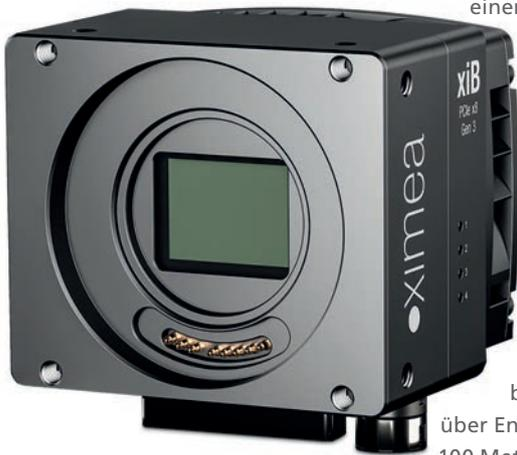
einer Auflösung von 16 Mpix (4.704 x 3.424 Pixel) bis zu 300 fps auf. Die verwendete PCIe3.0-Schnittstelle könne Bilddaten mit 64 Gbps (8.000 MB/s) übertragen – mithilfe von Glasfaserverbindungen sogar über Entfernungen von 100 Meter hinweg. Die
