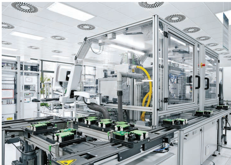
Bild 3: Phoenix Contact stellt Trennverstärker teilweise als konfigurierbare Varianten in einer Produktionsanlage her, die nach Industrie-4.0-Gesichtspunkten arbeitet.
