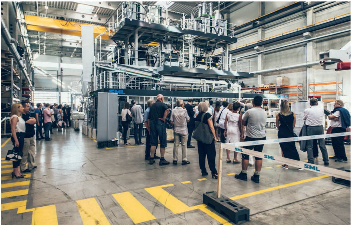
Die Gäste bestaunten eine Castfolienanlage zur Herstellung von Stretchfolie – eine der leistungstärksten Anlagen von SM.
