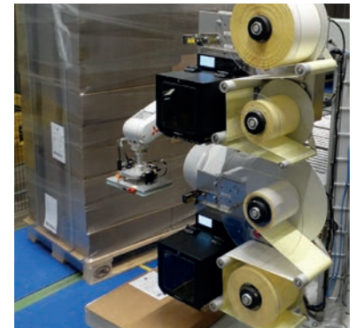
Eines der neuesten Projekte bei Bluhm Österreich ist der „Pallet-Labeling-Robot“, eine höchst flexible Roboterlösung zur Palettenetikettierung.
