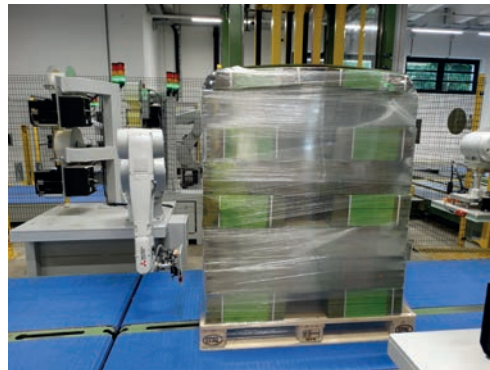
Eines der neuesten Projekte bei Bluhm Österreich ist der „Pallet-Labeling-Robot“, eine höchst flexible Roboterlösung zur Palettenetikettierung.
