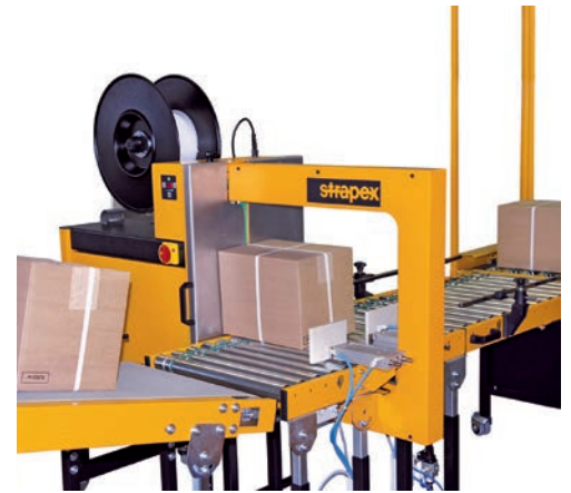
Vollautomatische Umreifungsmaschine, integriert im Produktionsprozess
