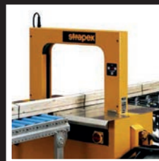
Hochleistungsmaschinen zum voll- bzw. halbautomatischen Umreifen
