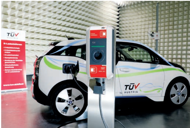
E-Mobility, E-Ladeinfrastruktur und Elektromagnetische Verträglichkeit in der größten EMV-Halle Österreichs im TÜV AUSTRIA Technology & Innovation Center.
