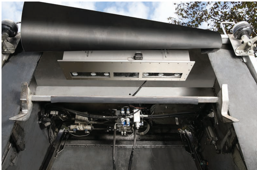
Der Wertstoffscanner erkennt mit Kameras und Sensoren, welcher Müll da gerade im LKW gelandet ist. Das Feedback sorgt wiederum für genauere Mülltrennung. Foto: Saubermacher/Robert Sommerauer
