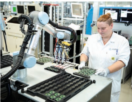
Die Greiferkonstruktion kann drei Platinen gleichzeitig handhaben.
