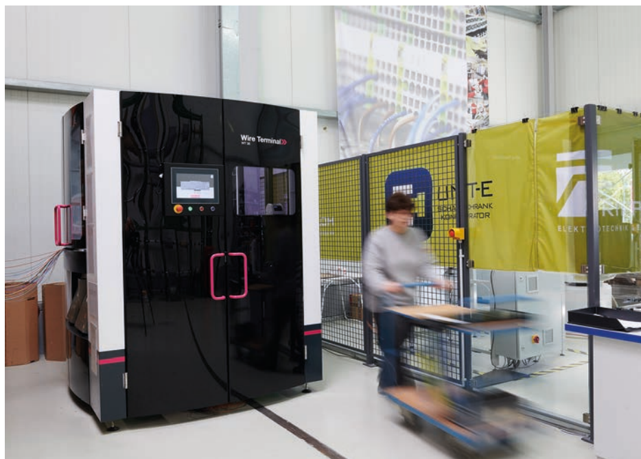
Die fertig konfektionierten Drähte werden in die Werkstatt transportiert, wo die Mitarbeiter sie im Schaltschrank verdrahten.
