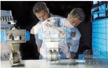
Montage eines Kugelhahns mit pneumatischem Drehantrieb
