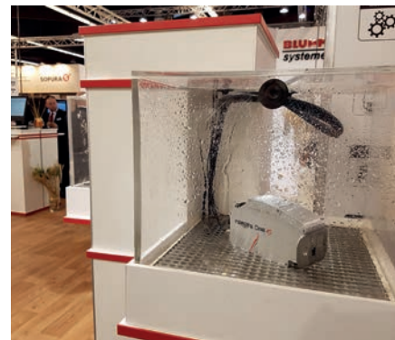
Der Druckkopf Integra One verfügt über die IP-Schutzklasse 65.
