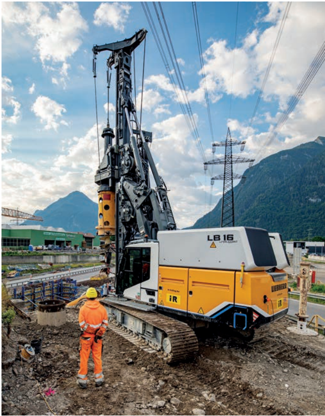
Elektrifizierend: Das LB 16 unplugged mit elektrohydraulischem Antrieb kann auch kabellos eingesetzt werden.
