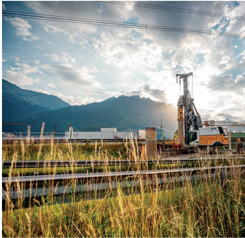
Überzeugend: Das erste akkubetriebene Großdrehbohrgerät der Welt bei seiner Performance in Bürs.
