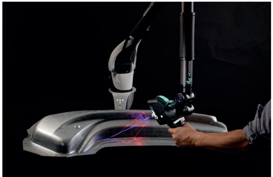
Der RS6-Laserscanner in Kombination mit dem Absolute Arm mit sieben Achsen stellt eine optimale Rundum-Lösung für das mobile Messen kleiner bis mittelgroßer Teile dar.
