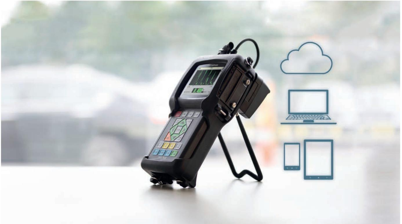
Adapter 38-Link von Olympus: Mit Ultraschalldickenmesser drahtlos kommunizieren.
