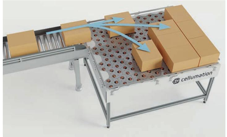
von Förderanlagen aneinanderfügen. Besonderheit: Mit der patentierter Einzelradsteuerung werden die Antriebsräder jeweils einzeln angetrieben. Dadurch können Pakete völlig frei auf einer Ebene bewegt werden und alle Aufgaben der Fördertechnik mit einem System realisiert werden.
