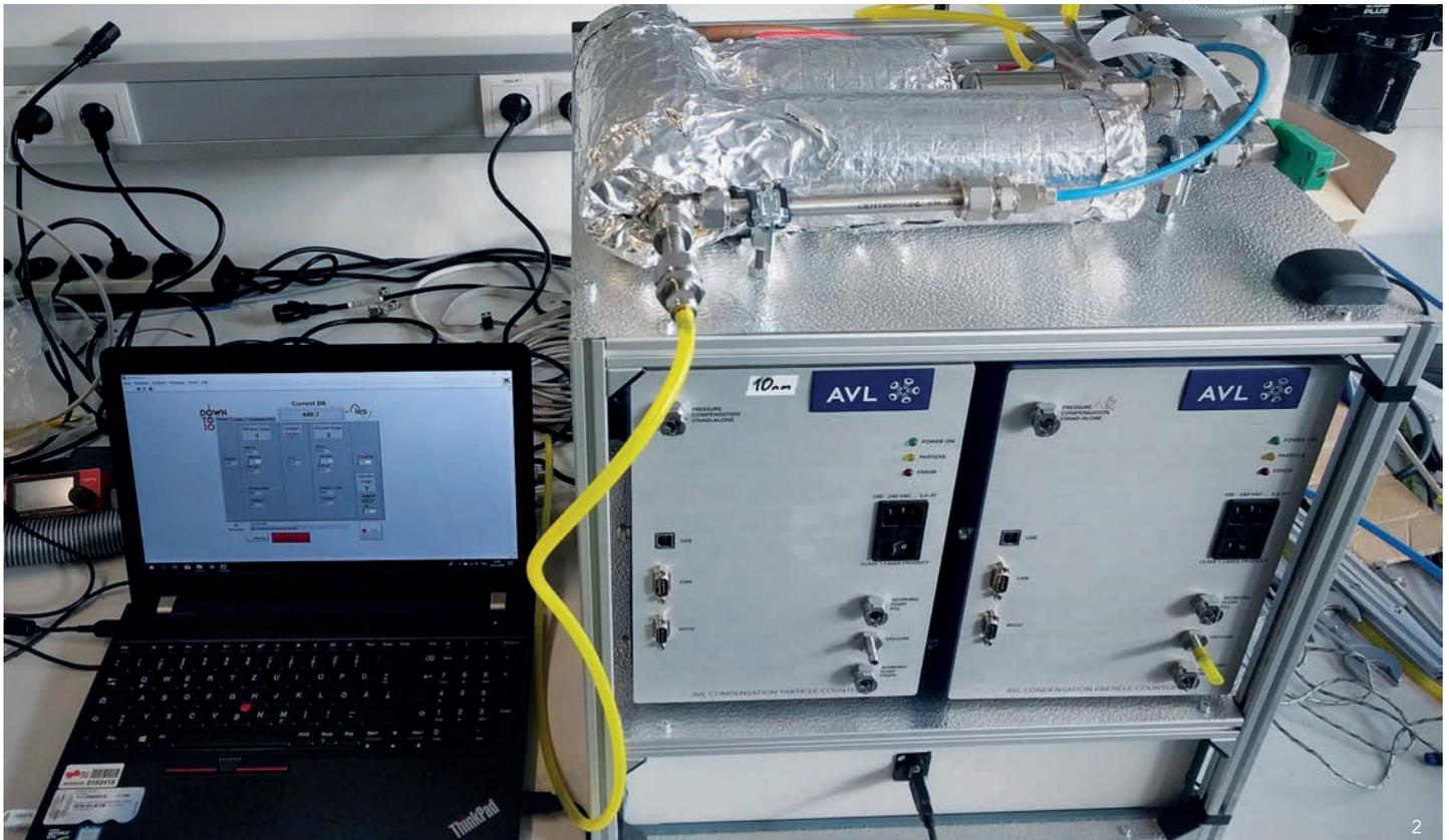
Das Messsystem hat in einem Auto gut Platz. Es soll der Auto-industrie dabei helfen, bessere Motoren zu entwickeln, die weniger Nanopartikel emittieren als aktuelle Verbrennungsmotoren.
