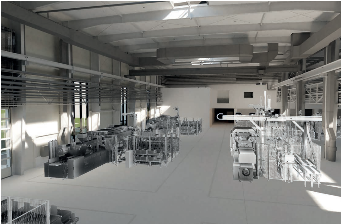
Produktionsbasierte Planung: Bei der Planung wurde das Gebäude als Maschine verstanden. Sämtliche Fertigungsprozesse mit ihren Energie- und Materialflüssen sowie alle produktivitätsrelevanten Umgebungsbedingungen wurden bereits in der Planungsphase mitberücksichtigt.
