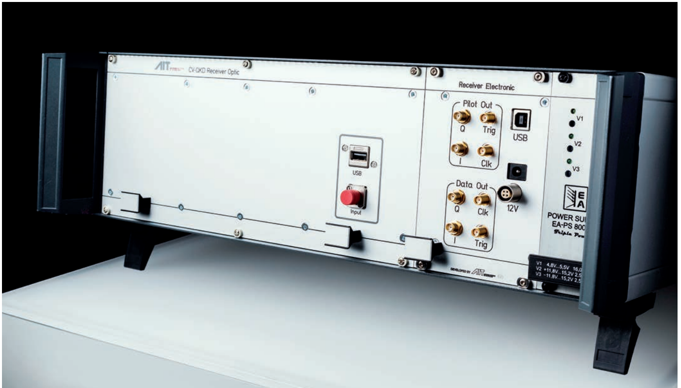
Empfangsgerät für Daten, die mit Quantentechnologie verschlüsselt werden.
