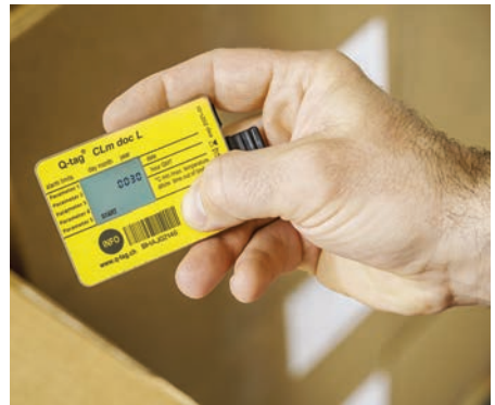
Q-tag CLm doc überwacht temperaturempfindliche Impfstoffe und Medikamente.
