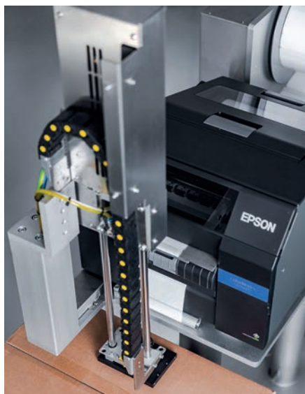
Der Legi-Air 6500 ermöglicht eine 1:1 Etikettierung mit Farbetiketten.
