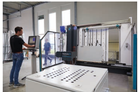
Das Bearbeitungszentrum Perforex BC von Rittal übernimmt vollautomatisch das Bohren, Fräsen und Gewindeschneiden an Flachteilen und Gehäusen.
