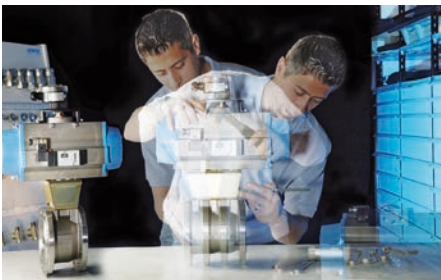
Montage eines Kugelhahns mit pneumatischem Drehantrieb
