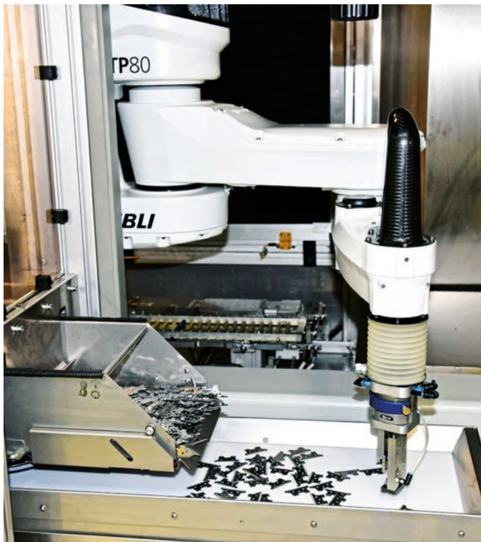
Der FAST picker TP80 greift die ungeschliffenen Schneidmesser vom Band ab und legt sie in High-speed präzise in eine Bestückungsleiste ein.
