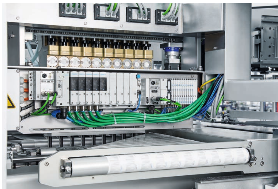
Digitale Pneumatik im Einsatz: Bosch Packaging Technology setzt bei seiner Flachbeutelmaschine Sigpack VPF auf die Flexibilität des Festo Motion Terminals VTEM.
