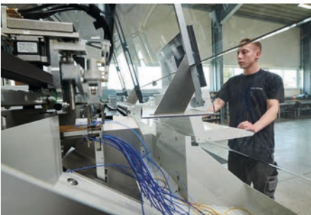
Die vollautomatische Drahtkonfektionierungsmaschine gibt fix und fertig bearbeitete Drahtsätze samt Beschriftung und eindeutiger Kennzeichnung aus.
