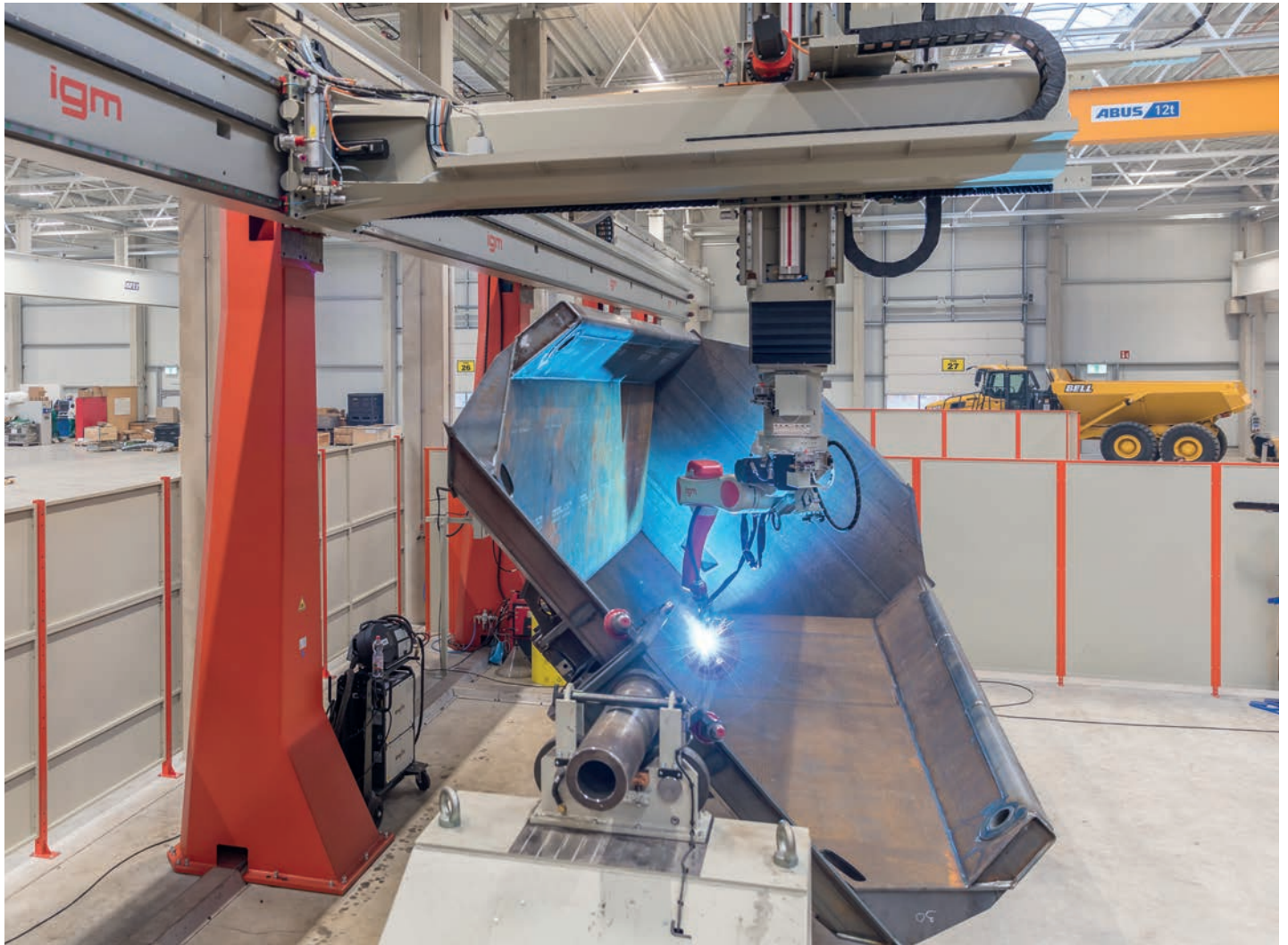
Zum Ausschweißen der Kippermulden werden igm-Schweißroboteranlagen eingesetzt. Das teleskopierbare Vertikalfahrwerk spart an Bauhöhe und erlaubt dennoch das Eintauchen in das Bauteil.
