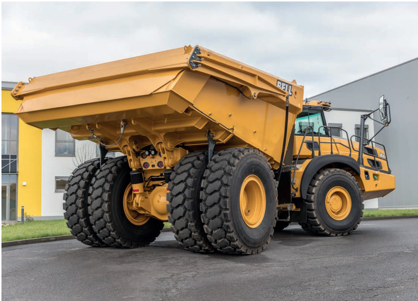
Mit einer Nennnutzlast von 55 Tonnen und einer Motorleistung von 430 Kilowatt ist dem knickgelenkten Muldenkipper BE60E von Bell Equipment nichts zu schwer.
