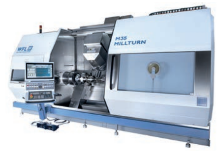
M35 MILLTURN mit ergonomischem Bedienpult und zahlreichen neuen Features
