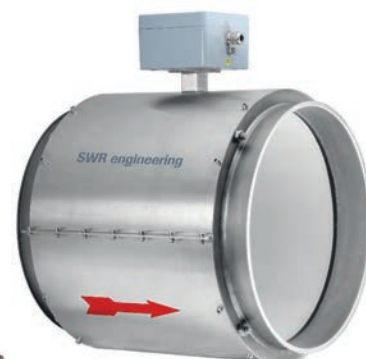
Der SpeedFlow 2.0-Pipe kann in Freifallleitungen und in pneumatischen Förderleitungen eingesetzt werden, um die Geschwindigkeit der Partikel zu messen.
