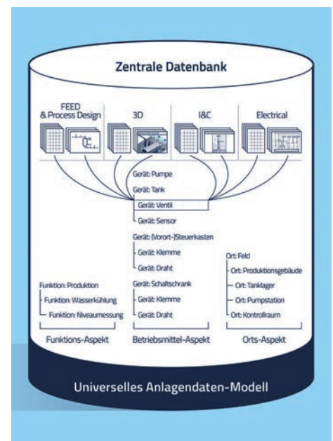
Bild oben: Das universelle Modell in EB ist die Basis für alle Kerndisziplinen des Anlagen-Engineerings und die Kommunikation mit ergänzenden Systemen.
