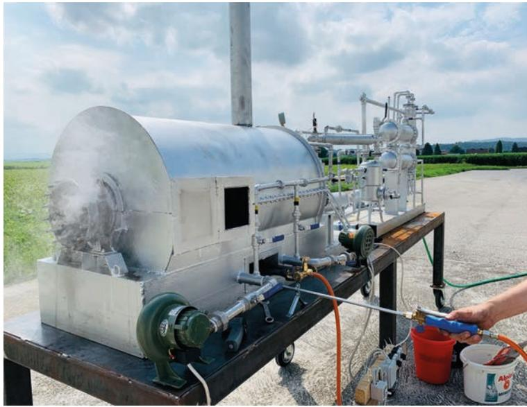
In dieser Demo-Anlage werden Kunststoffabfälle durch Pyrolyse umgewandelt.
