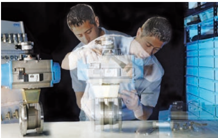
Montage eines Kugelhahns mit pneumatischem Drehantrieb
