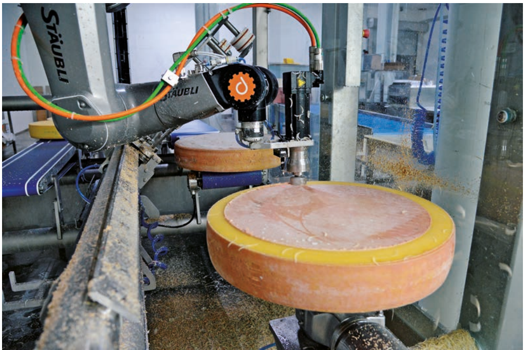
Mit einer Taktzeit von rund zwei Minuten wird heute die Rinde in gleichbleibender Stärke mit exakter Bahnverfolgung abgefräst. Bis dato dauerte das manuelle Abschaben rund zehn Minuten pro Laib.
