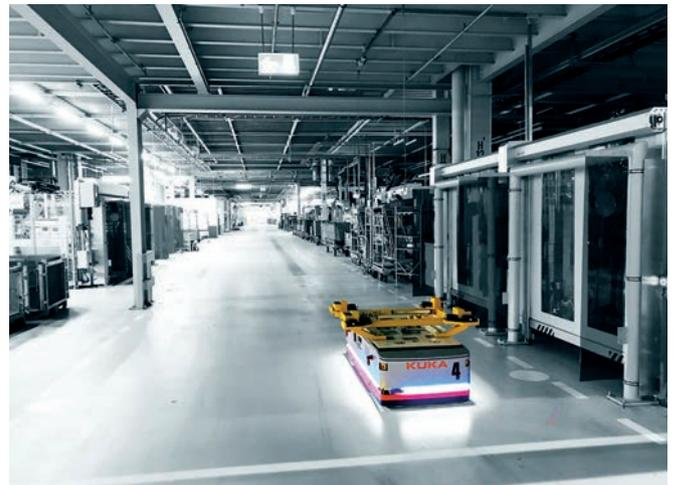
Bauteilbehältern beliefern sowie leere Behälter wieder abtransportieren. Darüber hinaus interagiert die Software mit anderen (automatisierten) Fahrzeugen, Maschinen und Mitarbeitern und reagiert flexibel und sicher auf die sich ständig ändernden Anforderungen an die Produktion. 16 weitere KMP 1500 werden künftig bei BMW für den flexiblen Materialfluss einer zusätzlichen Produktionslinie sorgen.
