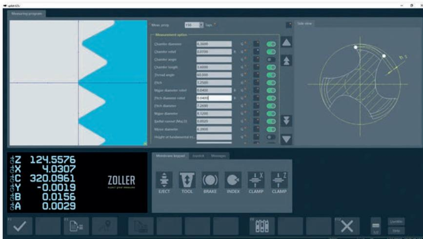
»threadCheck« mit »pilot 4.0«: Der schwenkbare Multisensor-Optikträger »orthoScan« findet immer den perfekten Blickwinkel auf das Werkzeug und misst somit auch bei steigungsbehafteten Werkzeugen verzerrungsfrei und  $\mu\text{m}$ -genau.
