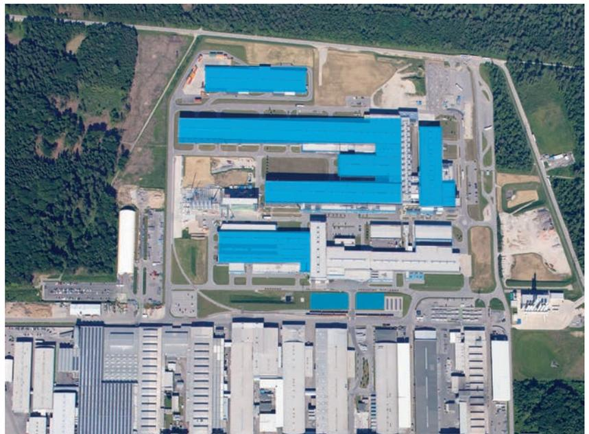
Die 55.000 m<sup>2</sup> Dach- und Freiflächen, auf welchen die neuen Photovoltaikanlagen errichtet werden (blau markiert)
