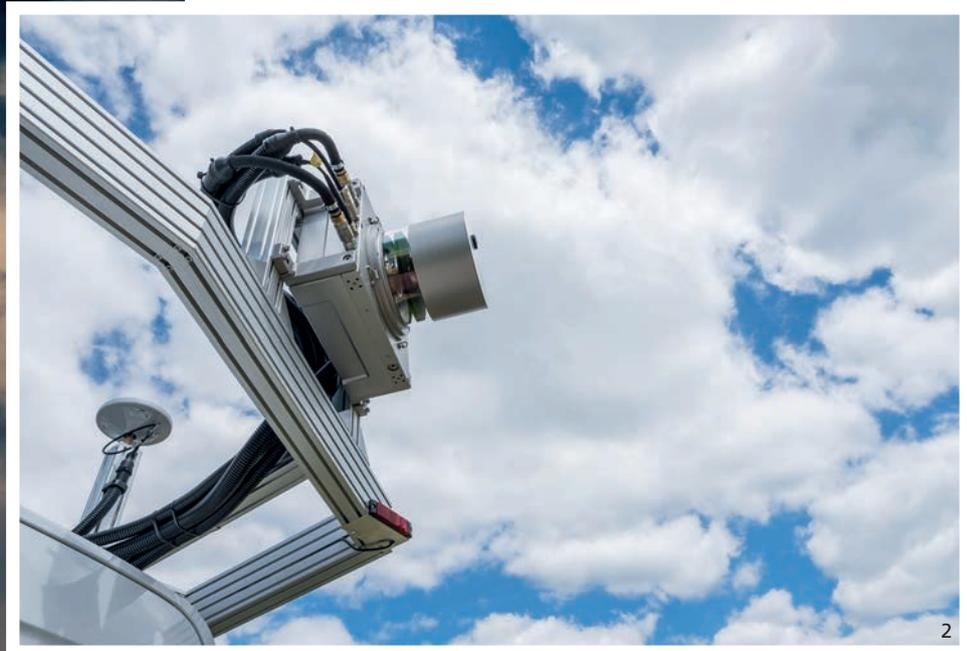
Das TIS misst zwei Millionen Messpunkte pro Sekunde. Das heißt, der Messstrahl legt zwei Millionen Mal pro Sekunde die Distanz vom Messgerät zum zu untersuchenden Objekt zurück.
