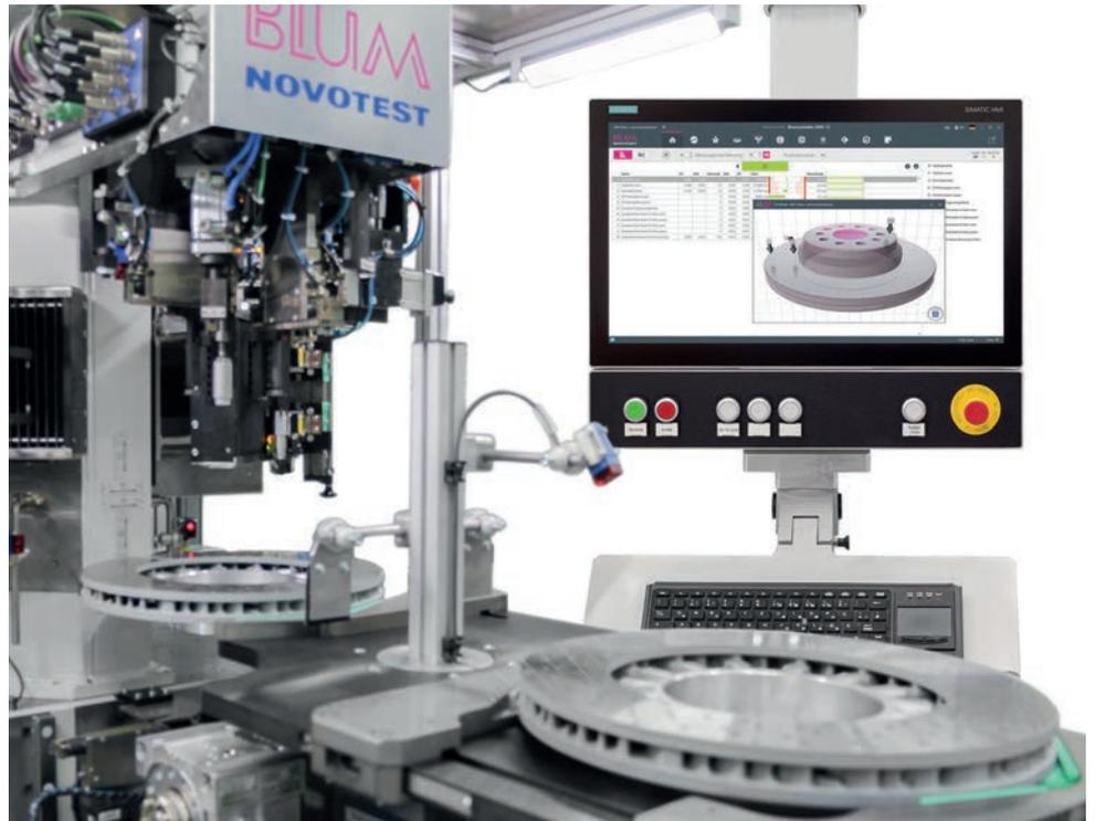
Die Mess- und Auswertesoftware M4P wurde speziell für die Post-Prozess-Messanlagen von Blum-Novotest entwickelt.
