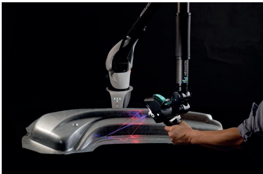
Der RS6-Laserscanner in Kombination mit dem Absolute Arm mit sieben Achsen stellt eine optimale Rundum-Lösung für das mobile Messen kleiner bis mittelgroßer Teile dar.
